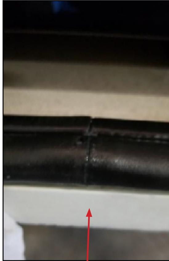
**WIPE EXCESS SILICONE OFF THE OUTER PORTION OF DOOR GASKET BULB AND EDGE TRIM.**
